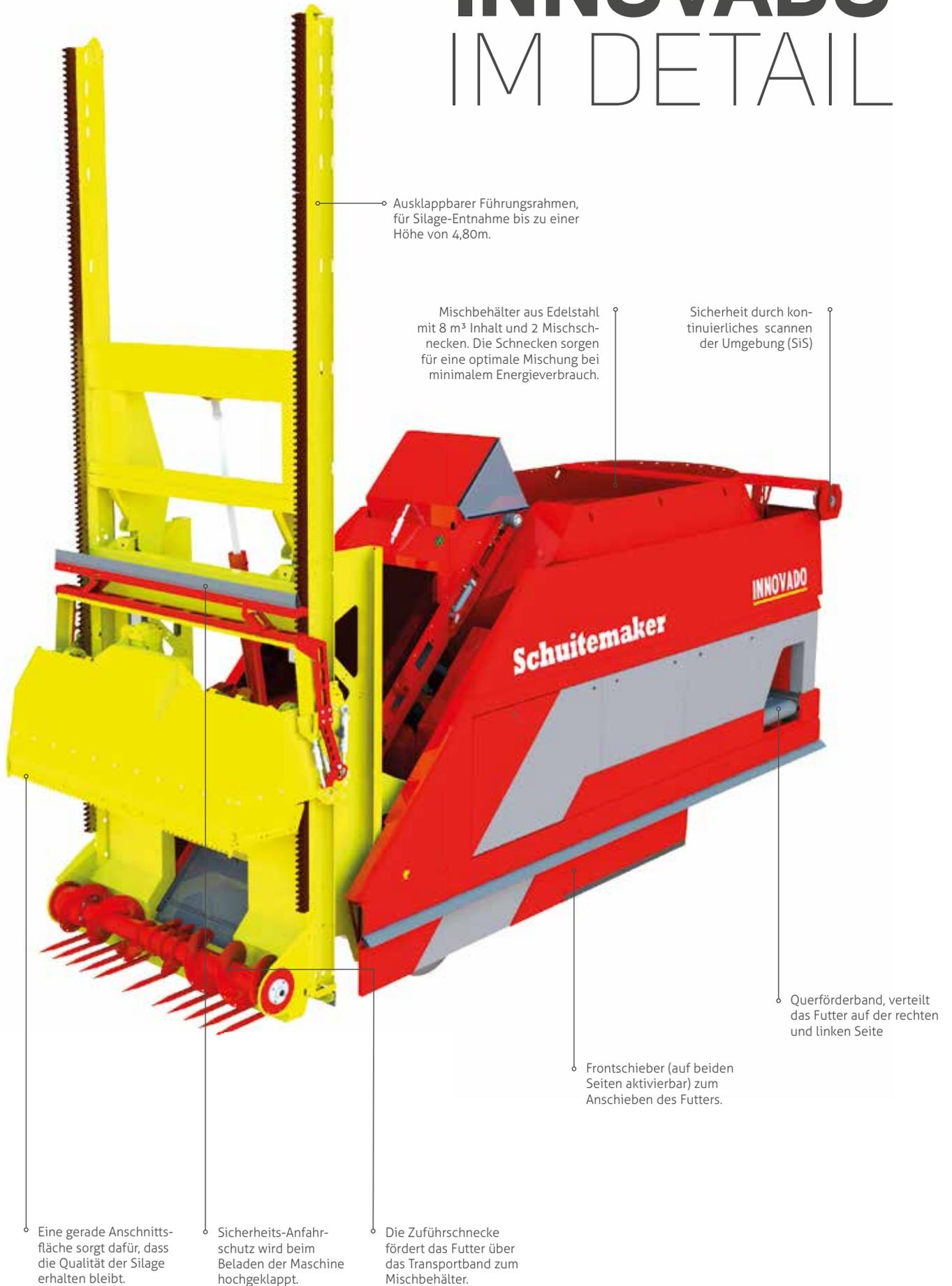
Ausklappbarer Führungsrahmen, für Silage-Entnahme bis zu einer Höhe von 4,80m.
